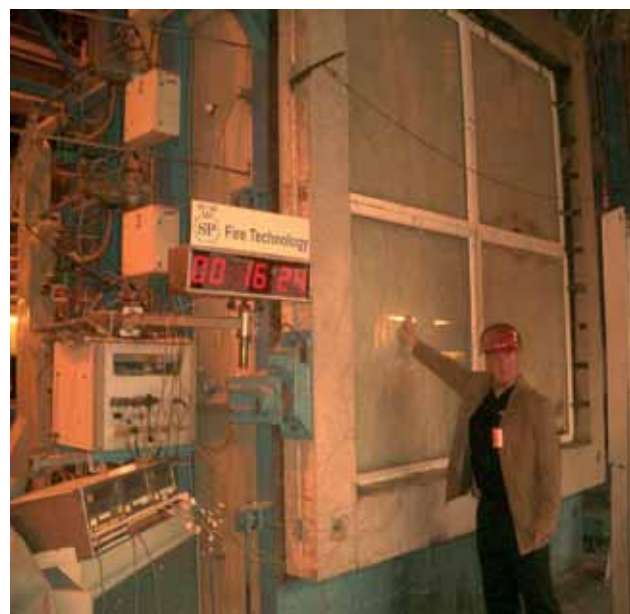
Etter 16 minutter er det fortsatt mulig å legge hånden på glasset på grunn av den gode isolasjonsevnen brannglasset har. Inni ovnene er det nå ca. 900 grader Celsius
